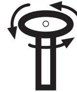
Gire las válvulas del tanque a la IZQUIERDA para abrirlas por completo. Las válvulas del tanque deben estar en posición vertical durante su uso.
