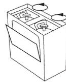
En tournant les robinets DANS LE SENS CONTRAIRE AUX AIGUILLES D'UNE MONTRE, ouvrir les deux robinets complètement. Le rabat supérieur peut être enlevé ou laissé en place pendant l'utilisation ou le stockage.
