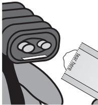
Antes de conectar la boquilla, aplique vaselina en la parte delantera de la pistola. Después de conectar la boquilla, rocíe un poco en un recipiente de prueba. La unidad está lista para usarse.
