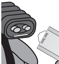
Avant de fixer la buse, utiliser de la vaseline sur le devant du pistolet. Après avoir fixé la buse, faire un essai de pulvérisation dans un conteneur pour essai. L'appareil est alors prêt à l'emploi.
