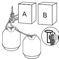
Visser le tuyau codé rouge au réservoir de composant A et le tuyau codé noir au réservoir de composant B et serrer avec une clé de 9 / 16 po.
