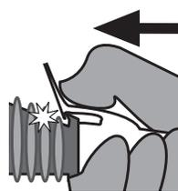
Attacher le loquet du haut en poussant vers l'arrière de l'appareil, jusqu'à ce qu'un "démic" sonore se fasse entendre.
