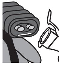
Inserte la lengüeta inferior de la boquilla en la ranura inferior de unidad de dispersión.
