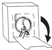
Appuyez en haut du panneau avant pour ouvrir. Abaissez le rabat pour l'installation du tuyau du dispositif d'application. Retirez la buse et lisez les instructions.
