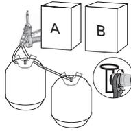
Enrosque la manguera de código rojo al tanque del componente "A" y la manguera de código negro al tanque del componente "B", y apriete con una llave inglesa de 9/16".
