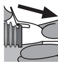
Para quitar la boquilla usada, empuje hacia arriba el sujetador superior y luego hacia adelante para desengancharla.
