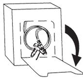
Empuje hacia adentro el panel anterior para abrir. Jale la tapa hacia abajo para efectuar el montaje de las mangueras de la unidad de dispersión. Saque el paquete con las boquillas y lea las instrucciones.
